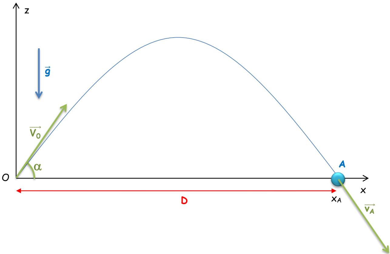
**Remarque:** La valeur  $V_A$  de la vitesse de l'objet en A est la même que celle de la vitesse à l'instant initial ( $V_A=V_0$ ). Seul l'angle avec l'horizontal est changé ( $-\alpha$ ).
