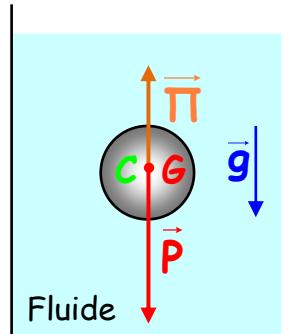
La poussée d'Archimède  $\vec{\Pi}$  exercée par un fluide de masse volumique  $\rho_{\text{fluide}}$  peut s'écrire:
